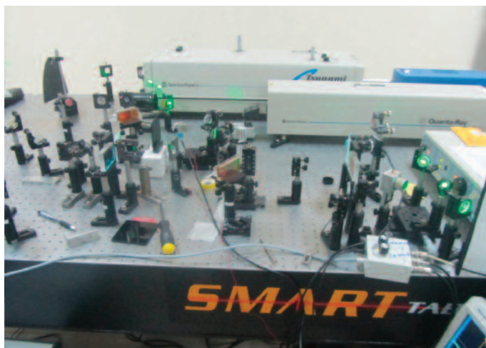
Hệ khuếch đại công suất cho xung laser femto-giây Ti: Sapphire.
